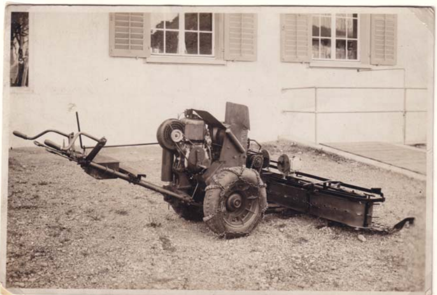
Eigenentwicklung Eingrasvorrichtung zu Rapid Typ L
